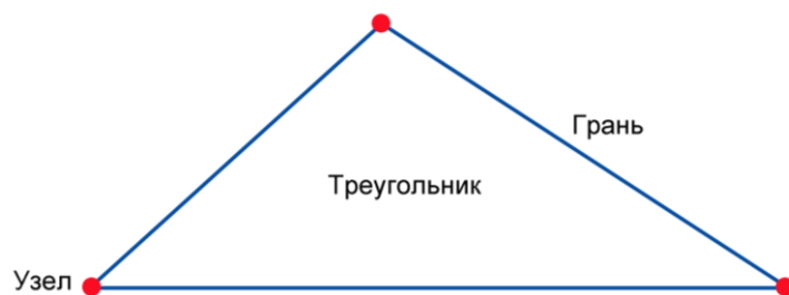
Рис. 2.7. Элементы треугольника TIN-модели
